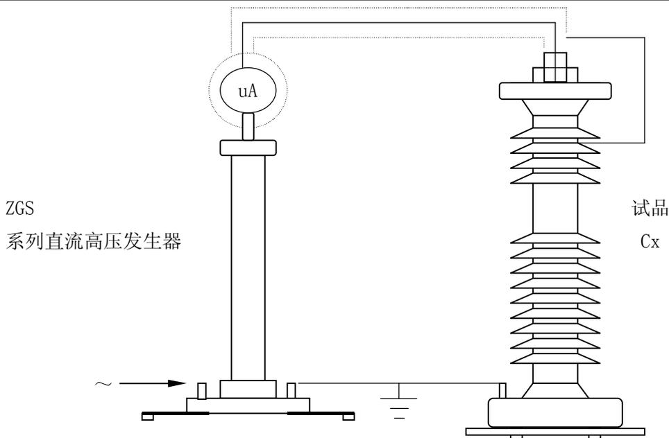
图 7b 排除试品表面泄漏电流接线图
