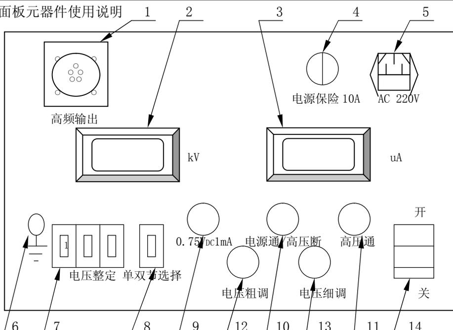
图 2 ZGS 系列直流高压发生器控制箱面板示意图(双节倍压)
