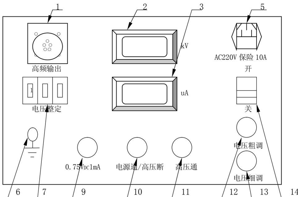
图 3 ZGS 直流高压发生器控制箱面板示意图(单节倍压)
